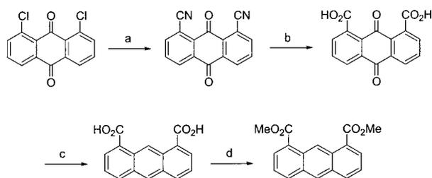
(a) i. CuCN, DMA; ii. HNO<sub>3</sub>. (b) H<sub>2</sub>SO<sub>4</sub>. (c) Zn, NH<sub>3</sub>. (d) Li<sub>2</sub>CO<sub>3</sub>, MeI, DMF.
